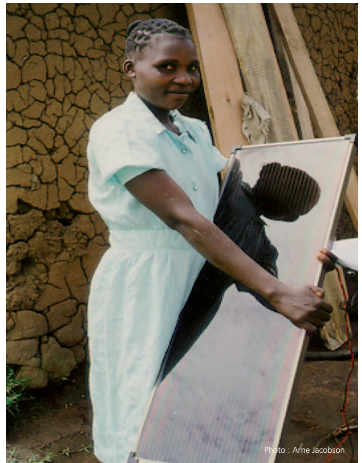
Schéma 12 Cellules photovoltaïques de petit format (système moyen – 18 watts) comme celles utilisées au Kenya. La taux d'adoption de cette technologie est plus élevé au Kenya que dans n'importe quel autre pays au monde 57 .
